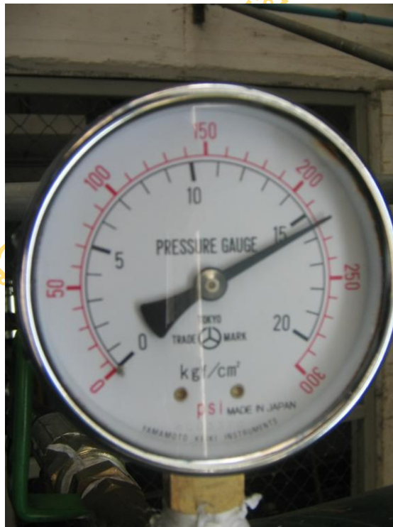
แรงดันทดสอบ Hydrostatic Test 220 psi, holding time 1/2 ชั่วโมง ไม่พบสภาพการรั่ว ซึม ปริ บวม ของถัง สามารถใช้งาน ทนแรงดันได้ต่อไป
